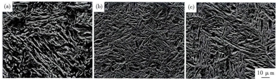
图 3 800 °C-250 °C (a), 900 °C-250 °C (b) 和 1 000 °C-250 °C (c) 淬火-回火后复合板 NM450D 钢侧的组织形貌
